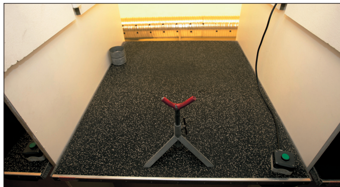
Hævesænkebord med gummioverflade og vaskbare vægge er to af de vigtige ting, når blystøv skal fjernes på en skydebane.
